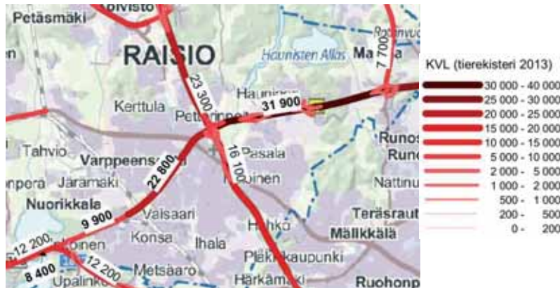
Kuva 3. Keskimääräinen vuorokausiliikenne (KVL, ajon./vrk) tieverkolla vuonna 2012 tierekisterin mukaan.
