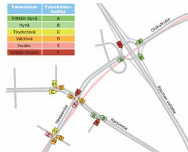
Kuva 21. Vaihtoehdon 1 palvelutasot vuoden 2030 iltahuippuun aikana aluevarausuunnitelman ennusteen mukaan. Valo-ohjattujen liittymien palvelutasot riippuvat merkittävästi käytettävistä ohjelmista ja yhteenkytkennöistä.
