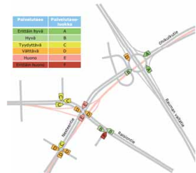
Kuva 26. Vaihtoehdon 2 palvelutasot vuoden 2030 iltahuipputunnin aikana aluevaraussuunnitelman ennusteen mukaan. Valo-ohjattujen liittymien palvelutasot riippuvat merkittävästi käytettävistä ohjelmista ja yhteenkytkennöistä.
