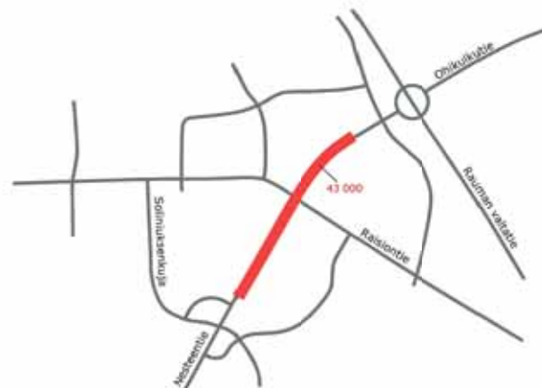
Kuva 32. Vaihtoehdon 4 liikennemäärät tunnelissa.
