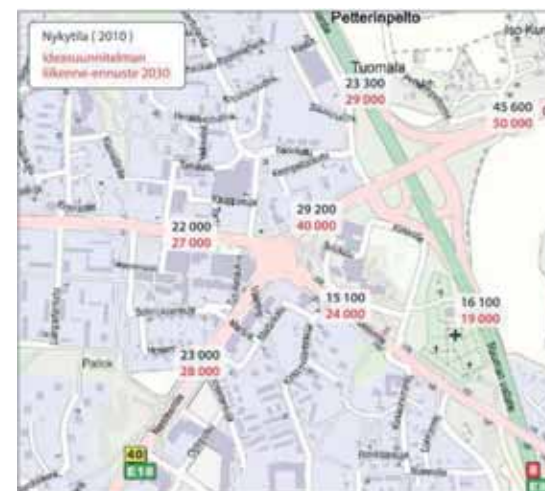
Kuva 7. Ideasuunnitelman liikenne-ennuste ja keskimääräinen vuorokausiliikenne (KVL, ajon./vrk) vuonna 2010.
