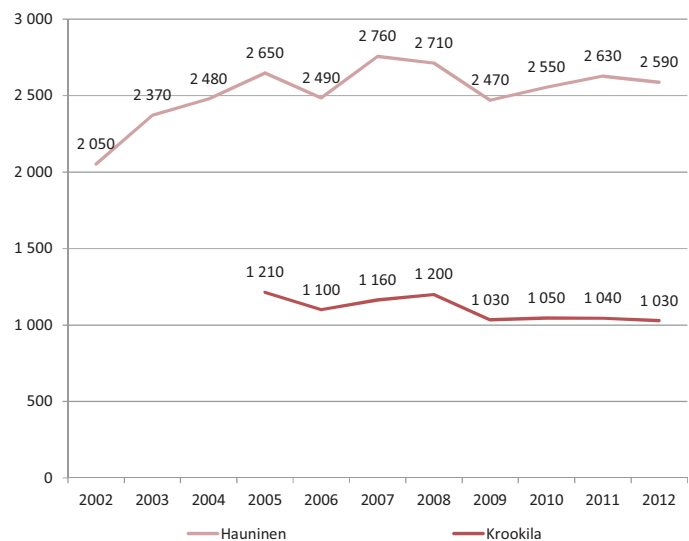
Kuva 6. Raskaiden ajoneuvojen keskimääräisen vuorokausiliikenteen (KVL rask ) kehitys E18-tiellä Krookilan (v. 2005–2012) ja Haunisten (v. 2002–2012) kohdalla.
