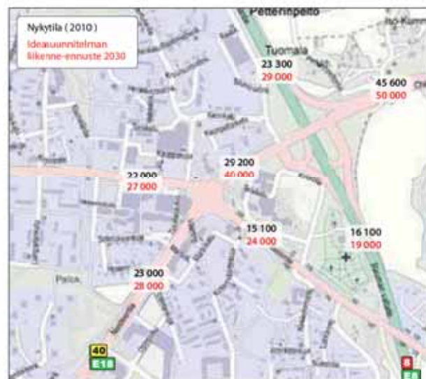
Kuva 6. Ideasuunnitelman liikenne-ennuste ja keskimääräinen vuorokausiliikenne (KVL) v. 2010.
