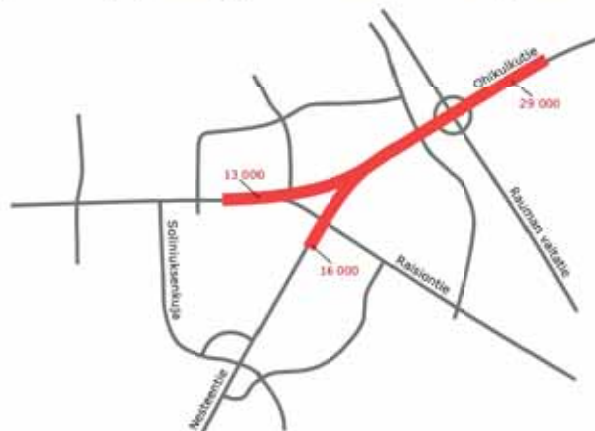
Kuva 23. Vaihtoehdon 2 liikennemäärät tunnelissa.
