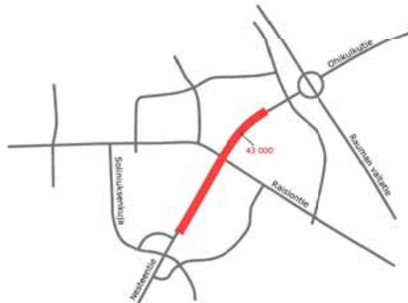
Kuva 28. Vaihtoehto 3 liikennemäärät tunnelissa.
